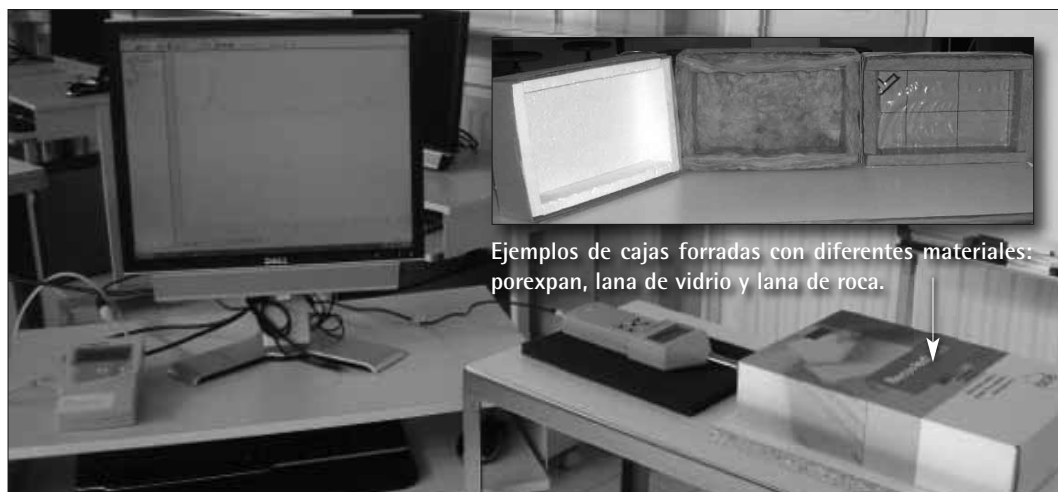
Figura 1. Un zumbador (intensidad de sonido conocida) se cubre con una caja forrada con el material que se quiera estudiar. Con el sonómetro conectado a la consola MBL y a través de ésta al ordenador, se mide y se representa mediante gráficas en la pantalla la intensidad del sonido dentro de la caja
