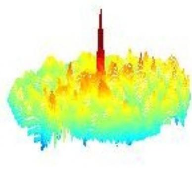
Kuva 2. Ultraääniterapiassa ääniaallot fokuoitetut ja tuottavat lämpöä. Vasemmalla: Skemaattinen kuva Richard Wolf yhtymän ultraääniaaltojen fokuoijasta. Oikealla: Kuopion yliopiston inversioryhmän simulaatioita fokuoitetun aallon amplitudista.
