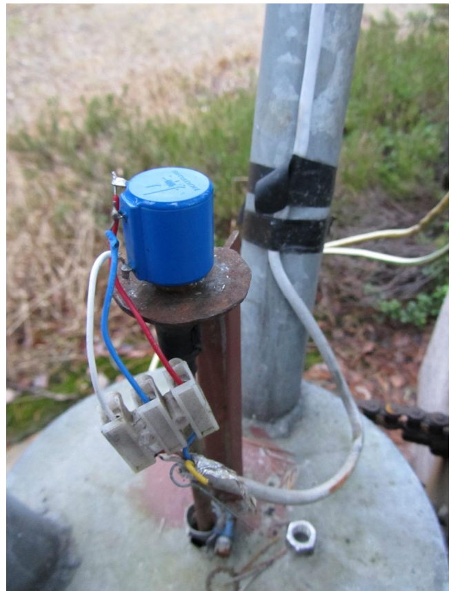
OG1M:n 'kisamenestyksen' avain: suunnannäyttöpottikka. (The component that determines the random ANT-azimuth at OG1M)
