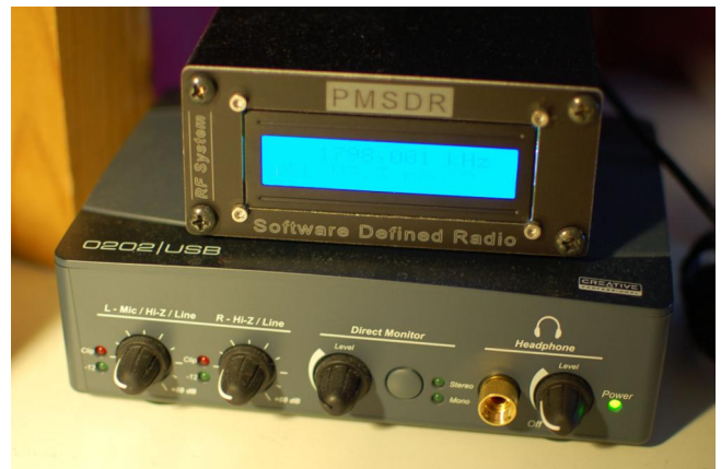
Olenneaisimmat rautaosat: äänikortti ja SDR-vastaanotin.
