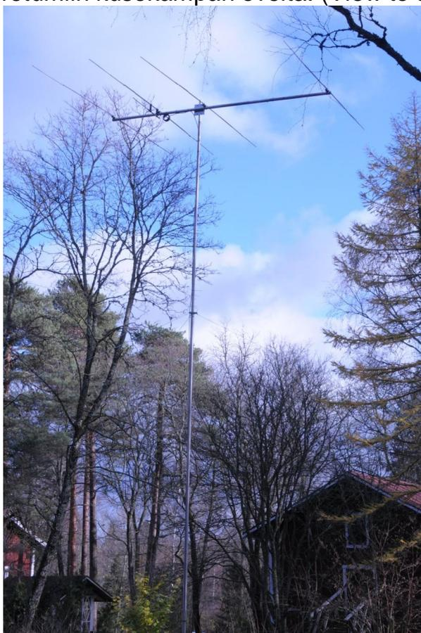
Kympin antenni. (Antenna for 28 MHz)
