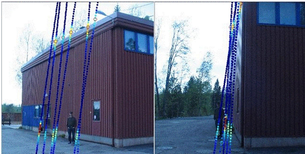
Kuva 92. Laserkeilaus ja fotogrammetria ovat 3D tiedonkeruumenetelmiä. Fotogrammetria on kohteen ominaisuuksien mittaamista valokuvilta, kun taas laserkeilaus perustuu lähetetyn valon käyttöön (valotutka). Lähifotogrammetriselle kuvaparille on tulostettu kilometrin korkeudelta ammuttujen ilma laserpulssien kulkureitti ja matkalta vastaanottimeen takaisinsironneen signaalin voimakkuus. Hyttiälä, Konehalli.
