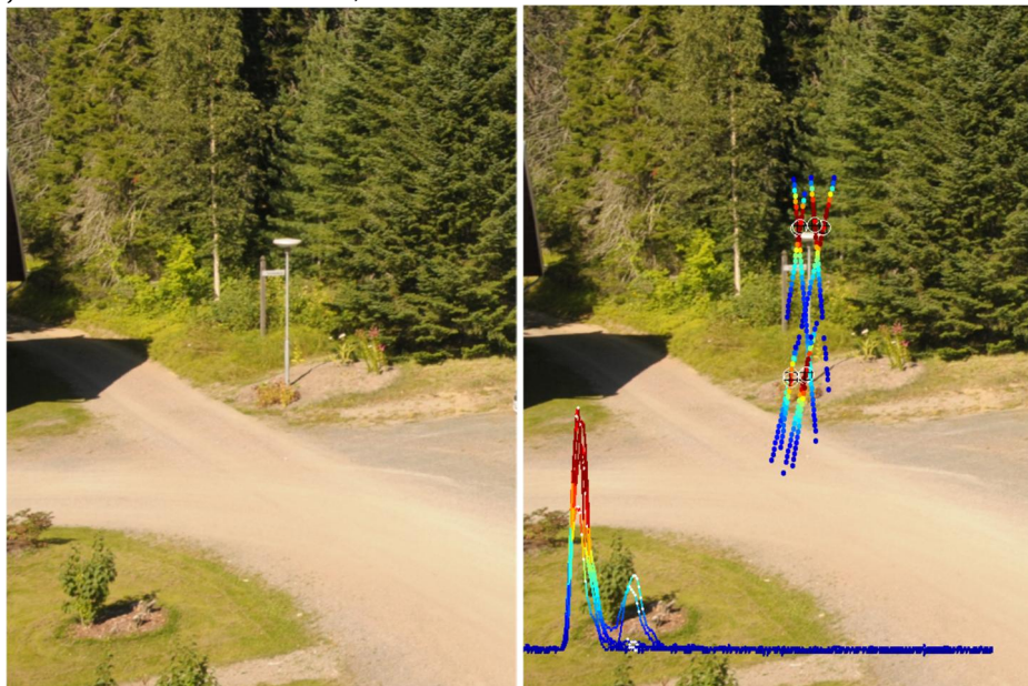
Kuva 110. 4 m korkeaan lyhtytolppaan osuneita laserpulsseja projisoituna maavalokuvalle (Kuva 101). Paluusignaalin amplitudiarvot on vastaanotettu 1 nanosekunnin eli 15 cm etäisyysvälein ja piirretty pisteinä pulssin reitille, jos amplitudi on ylittänyt kohinatason. Jokaisen pulssin 256 amplitudiarvoa on myös tulostettu asteikolle, joka on 38 m syvä (256 nanosekuntia pitkä aika-asteikolla). Tulostetut aaltomuodot on keskistetty ajan suhteen kaiuun, joka saatiin ensimmäisenä, joka "piikkää" noin syvyydessä 4 m (aaltomuodon tallennus käynnistyy 1. kaiusta ja tallennus sisältää puskuriin tallennettuja amplitudiarvoja noin 4 "edeltävän metrin" matkalta). Yksi pulsseista on tuottanut kaksi kaikua, toisen heikon lyhdystä, toisen vahvemman maasta. Lisäksi joukossa on lyhdystä kaiun tuottaneita pulsseja, joista on saatu heikko signaali maasta. Laserkeilauksessa käytettiin maksimissaan 15 asteen keilauskulmaa ja kyseistä maastonkohtaa keilattiin usealta lentolinjalta, mikä näkyy pulssien tulosuuntien vaihteluna.
