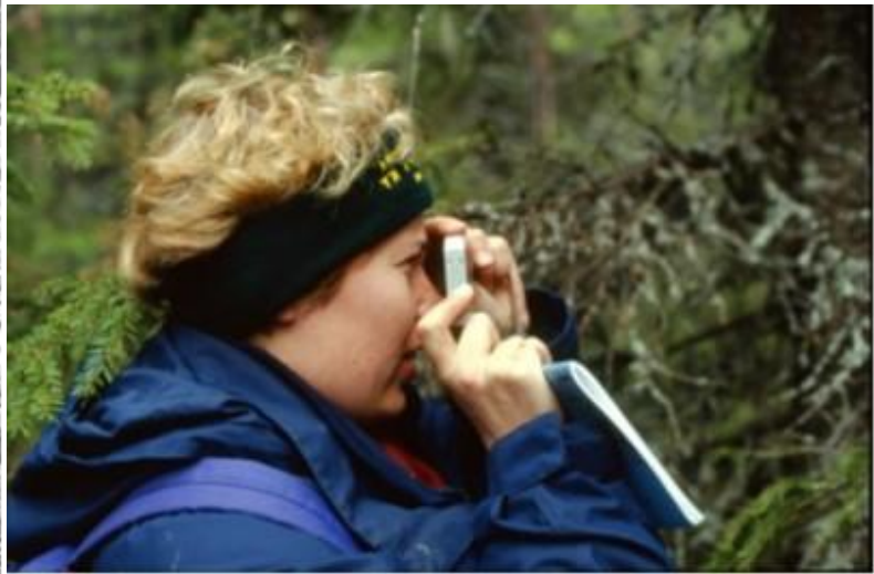
Kuva 132. Pituusmittaus hypsometrillä. Vasen: etäisyys puuhun mitattu metsurinmitalla, tähtäys latvaan käynnissä. Oikea: Etäisyyden mittaus latan avulla, jota tarkastellaan hypsometrin prisman läpi.
