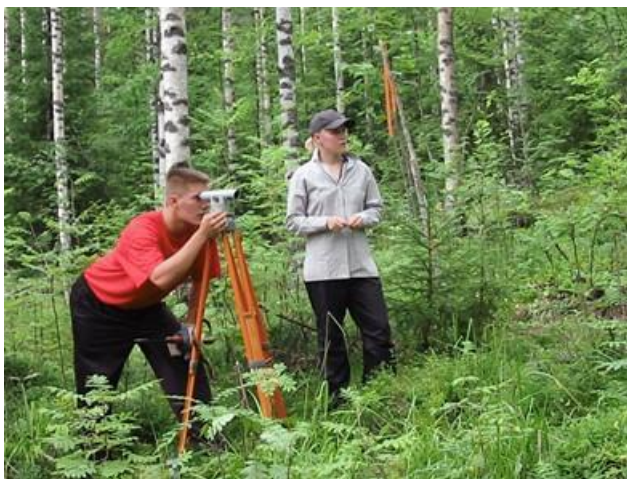
Kuva 84. Metsikkökoealan korkeusvaihtelun mittaaminen vaatuskoneella. Hyytiälä 2002 (kuva Markus Holopainen).
