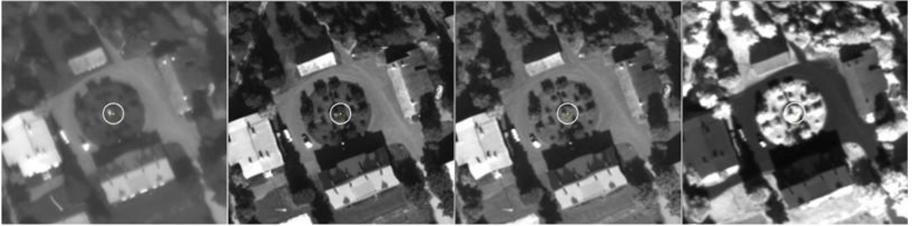
Kuva 98. Pihapiiri kuvattuna 4 km korkeudesta ADS40 rivikameralla, jossa on 4 tarkkaa (kaistanleveys 50 nanometriä) aallonpituusalueita, BLUE, GREEN, RED ja NEAR-INFRARED. Huomaa sinisen kanavan (aallonpituus 450 nm) heikko kontrasti (sumeus) ja heikot varjot. Infrapunalla (900 nm) kasvillisuus on kirkasta ja kirkas peltikattokin (rakennus vasemmalla) tumma. Kanavakohtaiset kuvat esitetään tässä mustavalkoisina (intensiteetti) kuvina.
