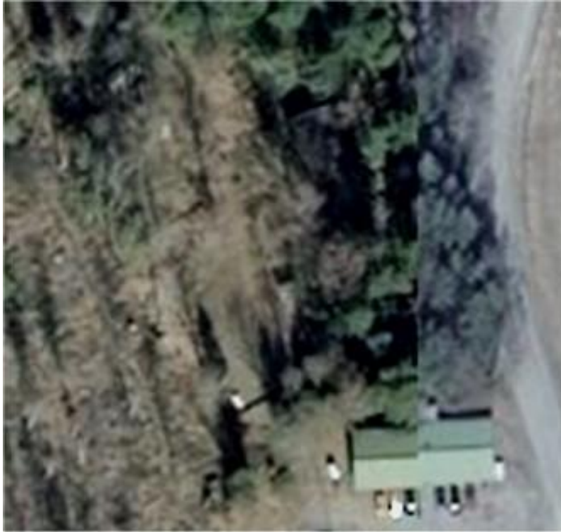
Kuva 103. Ortoilmakuvamosaikin sauma. MML - Kansalaisen karttapaikka, Nyby Porvoo. Huomaa katon harjan "liike" kuvasaumassa samoin kuin puiden erilainen "kaatumissuunta" sauman eri puolilla. Mosaiikki on koostettu eri kuvilta ja keskusprojektion erot aiheuttavat saumoissa "ongelmia" kohteille, jotka ovat maanpinnan yläpuolella, kuten rakennuksen katon harja. Myös sävyt muuttuvat saumassa, erityisesti, koska auringon ja kameran keskinäinen geometria ei täsmää.
