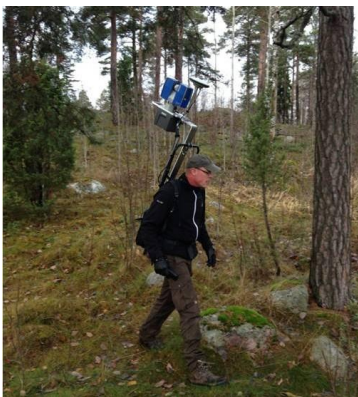
Kuva 127. Reppulaserkeilain. GNSS-vastaanotin ja inertiaalisensorit huolehtivat karkeasta paikannuksesta, joka jälkilaskennassa tarkentuu, kun reitin eri paikoista näkyneet samat kohteet sovitetaan yhteen korjaamalla reittiä. Laserscanning.fi (CoE in laser scanning reserach, http://wiki.awf.forst.uni-goettingen.de )
