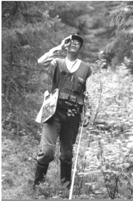
Kuva 132. Pituusmittaus hypsometrillä. Vasen: etäisyys puuhun mitattu metsurinmitalla, tähtäys latvaan käynnissä. Oikea: Etäisyyden mittaus latan avulla, jota tarkastellaan hypsometrin prisman läpi.
