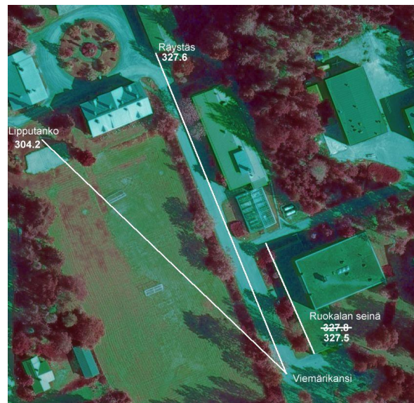
Kuva 2. Kalibroitaisuoria I: Viemärikansi – lipputanko 304.2°, Viemäri – tallin räystä 327.6°, Ruokalan seinä 327.5°.
