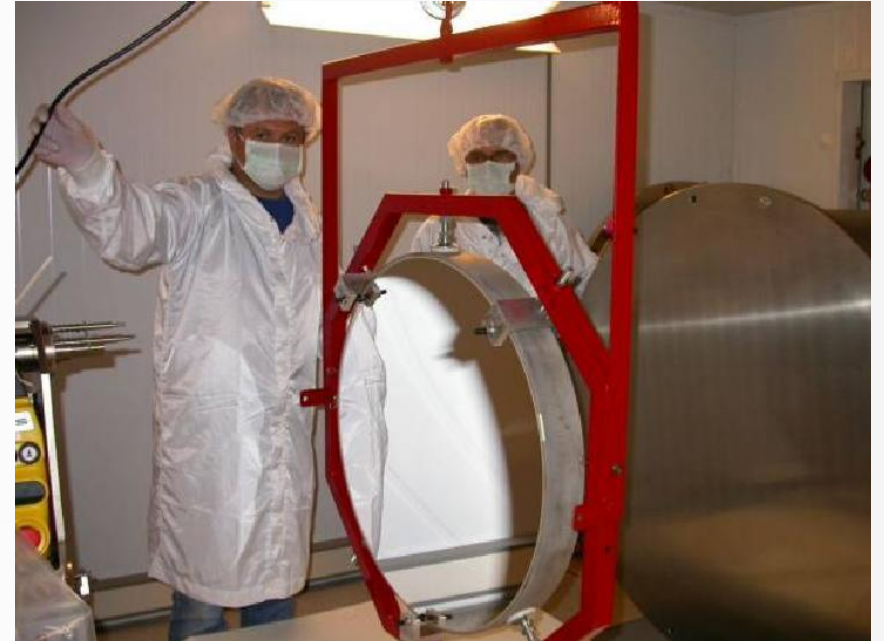
HARPS*-spektrometrin kollimaattori (ESO)
